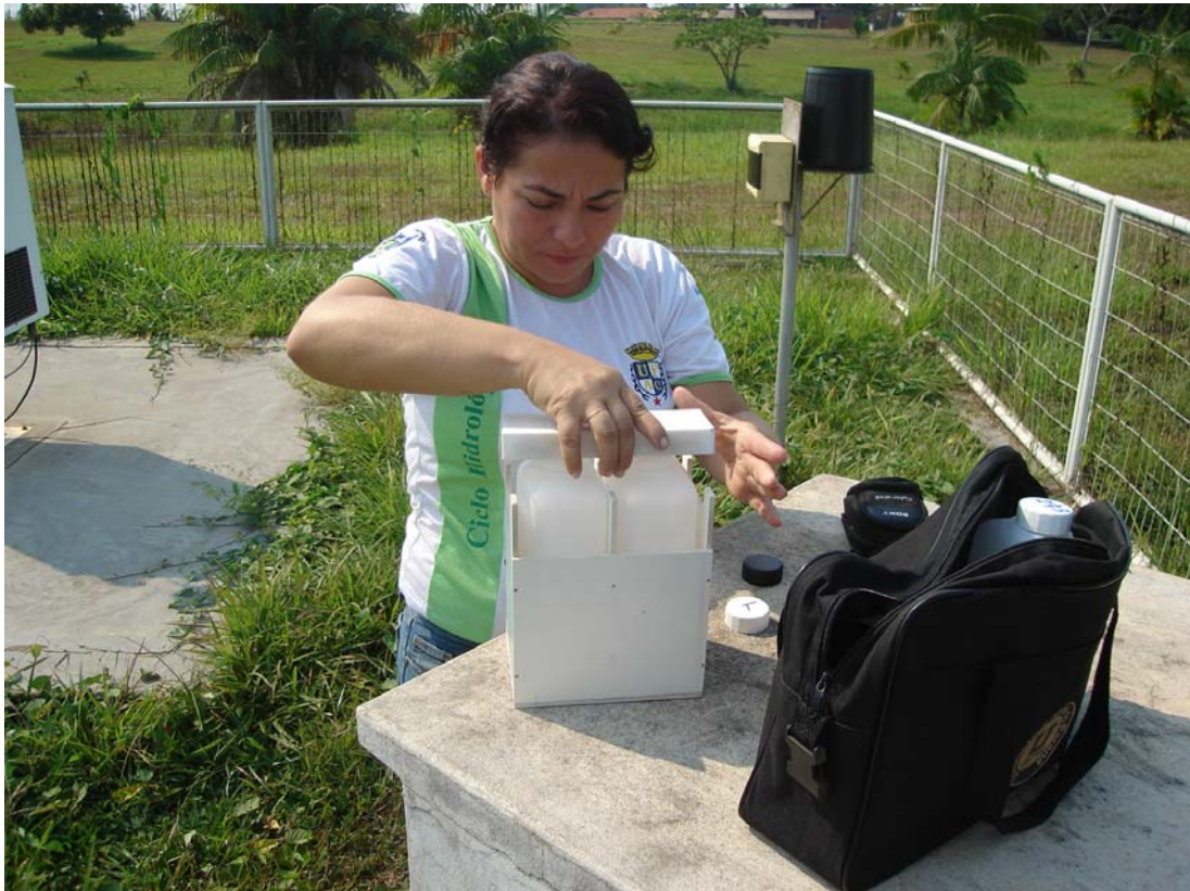
Figura 4. Na substituição das garrafas plásticas para coletar a água da chuva, no segundo plano, o pluviômetro para medir a altura de cada evento de chuva.
