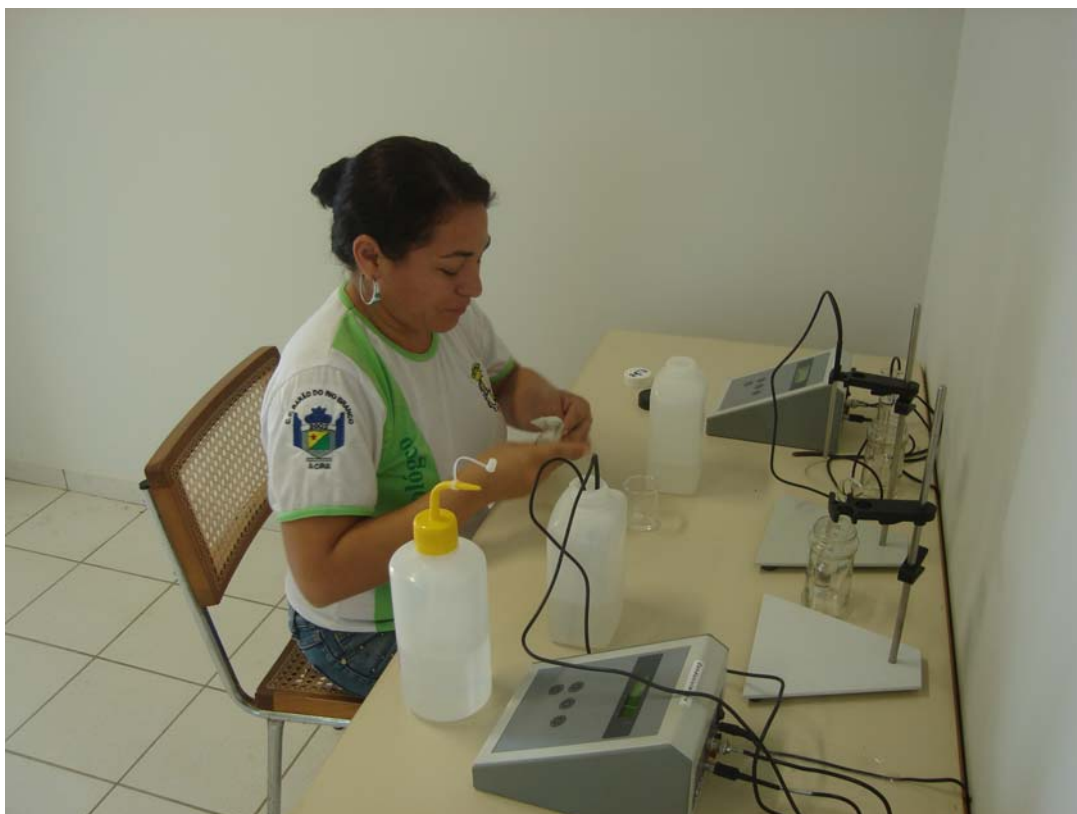
Figura 6. Determinação do pH e da condutividade elétrica da água de chuva.
