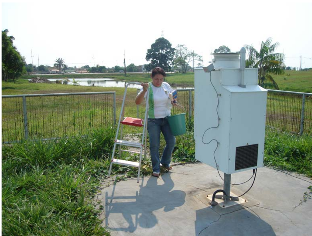
Figura 1. Chegada para a manutenção do amostrador de chuvas. 3
